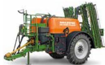
La gamme de pulvérisateurs trainés UG se renouvelle. Disponible en deux capacités : 2 200 et 3 000 l, elle s'équipe du terminal AmaTron 4 Isobus, tactile et couleurs. Les modèles sont pourvus d'une circulation continue basse pression, d'une station de lavage embarquée et du pack Confort (remplissage programmable, commande des rinçages, dilution en cabine...). Leur soubassement anthracite reprend le design des pulvérisateurs UX.
