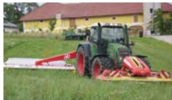
Le constructeur autrichien propose une faucheuse conditionneuse portée de 4 m de large : la NOVACAT 402 ED. Disponible avec un conditionneur à doigts, elle ne pèse pas plus lourd qu'un modèle de 3,50 m avec conditionneur à rouleaux. Elle s'utilise avec un tracteur à partir de 140 ch.
