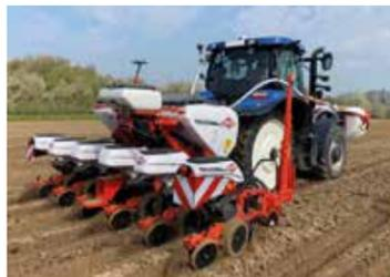
Le constructeur commercialise le semoir monograine Kosma qui se positionne entre les gammes Planter et Maxima. Il est destiné aux agriculteurs semant 100 à 500 ha/an sur un sol bien préparé. Les versions TD et TS (télescopique double et simple) disposent d'un châssis 6 rangs, d'une trémie de fertilisation de 950 l et d'enfouisseurs à disques. La version R (repliable), de 6 m de large, existe en version 8 ou 12 rangs.
